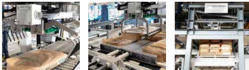
Портальный укладчик сочетает в себе преимущества традиционных высотных укладчиков и роботов-укладчиков. PRINCIPAL-P — это высокопроизводительный порталный укладчик, чья высокая скорость соответствует модели PRINCIPAL. При этом он оснащается захватом, адаптированным для конкретной сферы применения, например, комбинированным захватом для укладки мешков и коробок.
