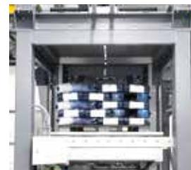
Высокоскоростной высотный укладчик на поддоны PRINCIPAL укладывает до 2400 мешков или коробок в час.
