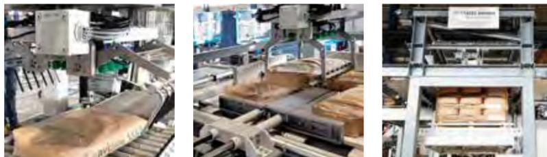
Высокопроизводительный порталый паллетизатор PRINCIPAL-P отличается высокой скоростью работы, присущей всем установкам PRINCIPAL, а также адаптацией захватов к конкретной области применения (например, путем использования комбинированных захватов для укладки на поддоны мешков и коробок).
