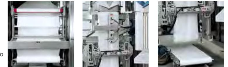
System-F — это полностью автоматизированная вертикальная установка для непрерывной упаковки, которая изготавливает мешки типа «подушка» и мешки с боковыми складками из плоской пленки. Мешки могут изготавливаться с ручкой для переноски или без нее. Масса наполнения находится в пределах от 5 до 50 кг. Установка System-F идеально подходит для упаковки порошкообразных продуктов и продуктов умеренной сыпучести.
