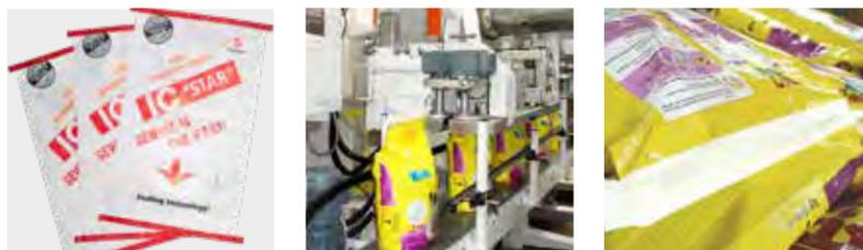
Запатентованная система запечатывания мешков «Over Tape Bag Sealer» от STATEC BINDER герметично запаивает тканые полипропиленовые (ПП) мешки. Для надежного и безопасного запечатывания используется полипропиленовая тканая лента. При необходимости мешки могут дополнительно зашиваться. Возможно запечатывание как мешков типа «подушка», так и мешков с боковыми складками.
