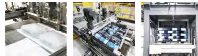
Высокопроизводительный высотный паллетизатор PRINCIPAL оснащается накопителем для пустых поддонов и системой отвода поддонов. Устройство уплощения мешков или конвейер с роликами квадратного сечения обеспечивает «надлежащую форму» мешков для укладки в штабель.
