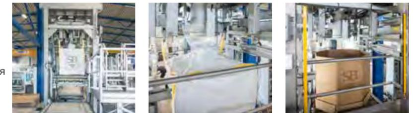
Полуавтоматическая станция обеспечивает наполнение больших мешков (гибких контейнеров средней грузоподъемности) с одной, двумя или четырьмя петлями, а также картонных коробов Octabin с массой наполнения от 500 до 1500 кг.
